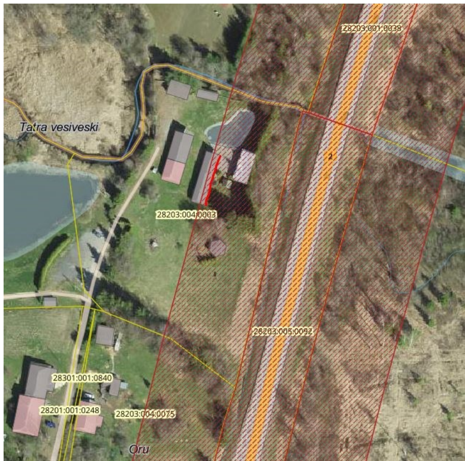
Joonis 1. Hoone kavandamine riigitee kaitsevööndisse, lubatud kaugus punase joonega olemasoleva hoone riigitee poolsel fassaadil; väljavõte Maa-ameti geoportaalist
